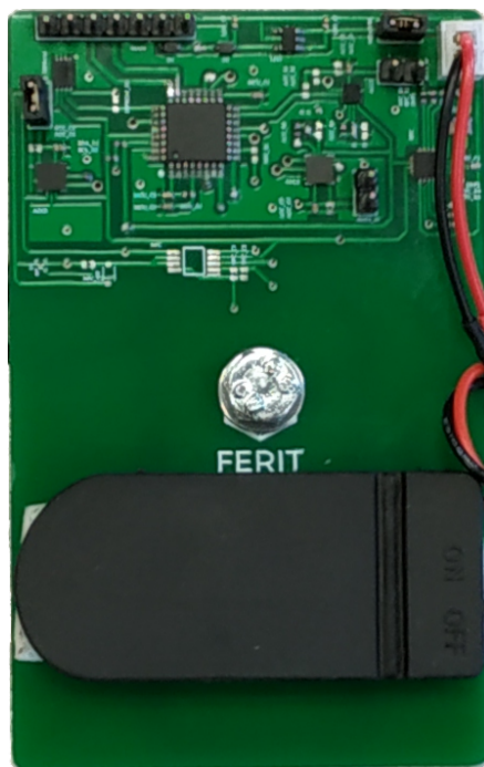
Slika 4.19: Prototip Pametne naljepnice za detekciju udara.
