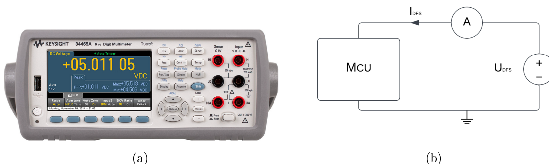
Slika 4.17: Mjerni postav uključuje: (a) Keysight 34465A multimetar, (b) dijagram mjernog postava.
